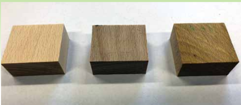
Slika 2: Vzorci kontrolne bukovine (levo), DMDHEU-modificirane bukovine pri 140 °C (sredina), DMDHEU-modificirana bukovine pri 170 °C (desno).
