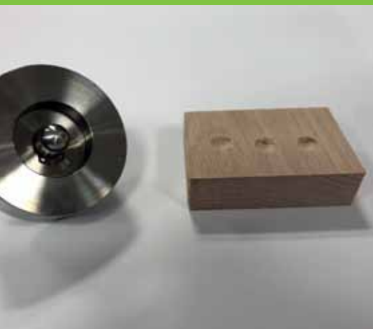
Slika 3: Testiranje trdote modificiranega lesa.
