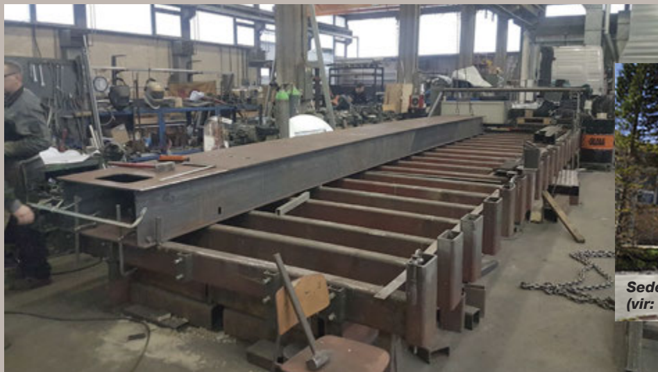
Izdelava nakladalnega platoja in centralnega nosilca polprikolice v podjetju HTT, d. o. o., v novembru 2019
