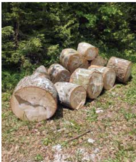
Koluti dolžine 40 cm za izdelavo majhnih čistih preizkušancev
