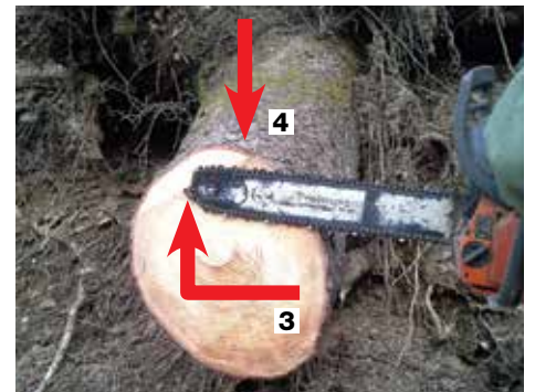
Postopek prežaganja debelejšega drevesa, ki je izruvano na ravnem ali po strmini navzgor.
