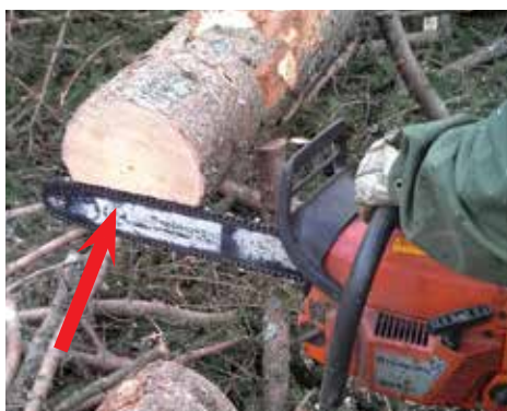
Prežaganje tanjšega drevesa s kombinacijo hrbtnega in trebušnega vzdolžnega reza glede na napetost lesnih vlaken.
