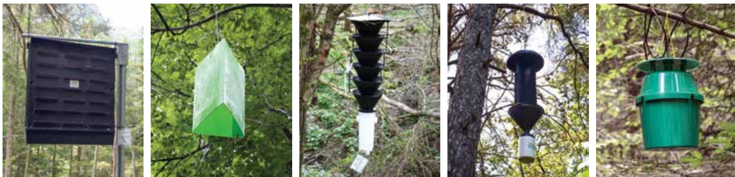
Različni tipi pasti, ki se uporabljajo za spremljanje karantenskih škodljivih organizmov v slovenskih gozdovih: a) režasta, b) lepljiva prizmatična, c) večlijakasta, d) lijakasta past (foto: S. Zidar).
