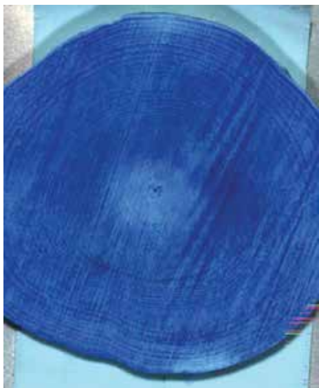
Hiperspektralna slika preseka smrekovega (zgoraj) in bukovega hloda (spodaj). Temnejša barva označuje les z večjo vlažnostjo.
