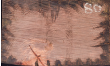
Presek bukovega železniškega praga, impregniranega z dvostopenjskim postopkom
