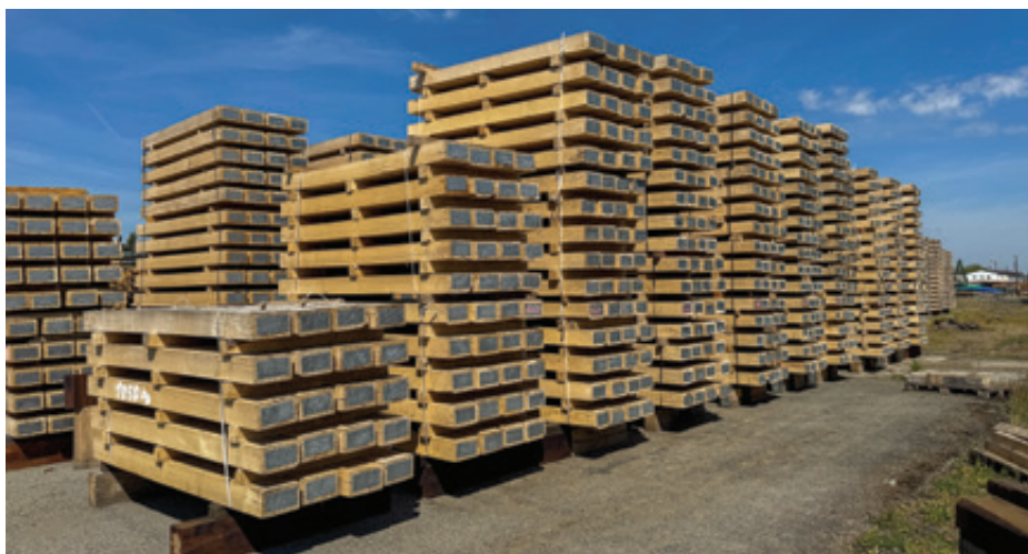
Skladovnica bukovih železniških pragov, pripravljenih za impregnacijo
